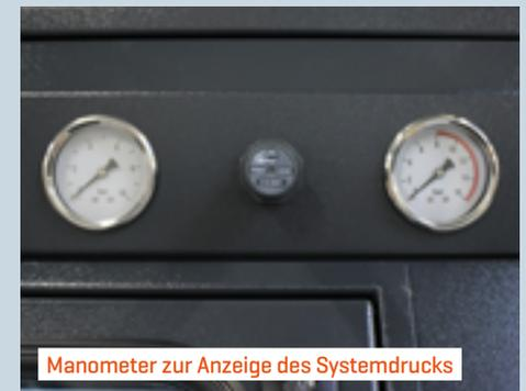
Manometer zur Anzeige des Systemdrucks
